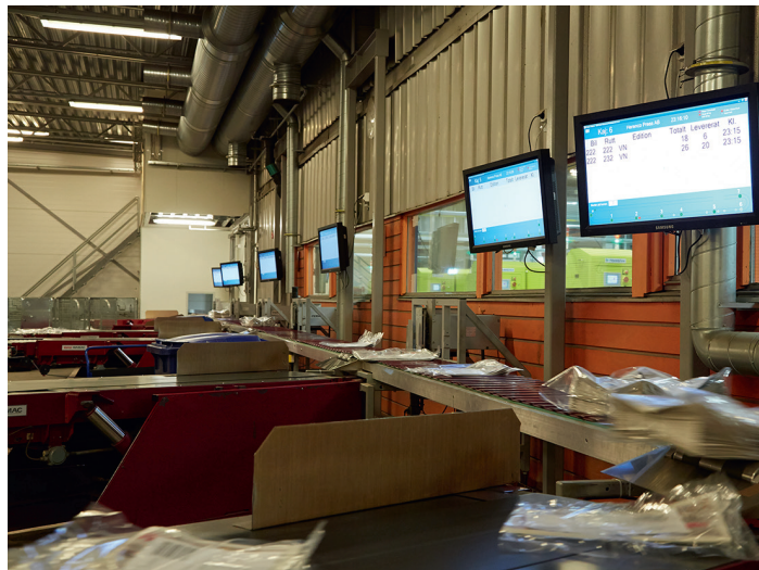
Rampenanzeigen informieren die Fahrer über den Fortschritt der Produktion.
