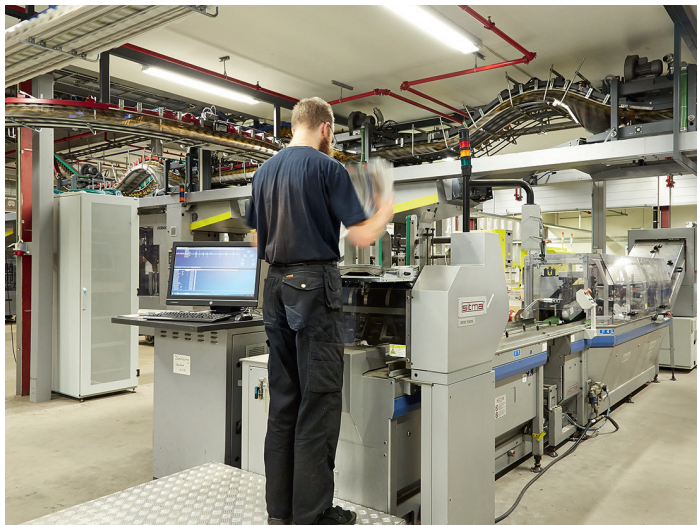
Eine Offline-Dreifalz- und Adressierlinie für die abonnierten Zeitungen ist steuerungstechnisch in das System integriert.
